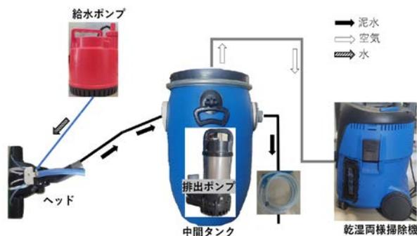
図 2 装置の構造図
