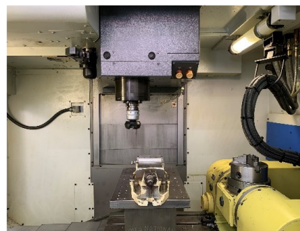
図-9 マシニングセンタの内部
