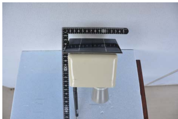
写真-1 小型水位計の外観
