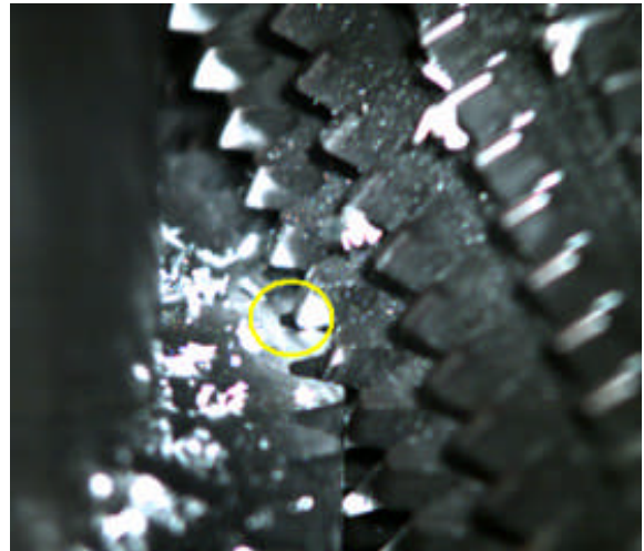
図4.2 コンベンショナルカットによる切粉挙動(写真)
