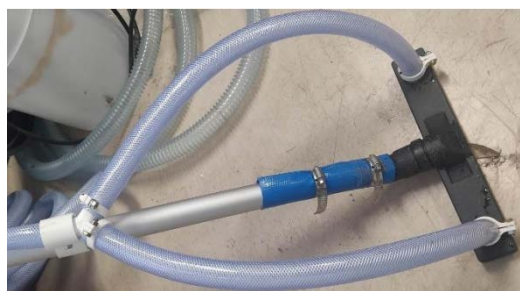
図7 吸引ヘット 最終形状
