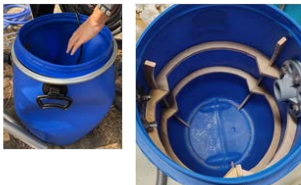
図4 つぶれた中間貯蔵タンクと補強リブ
