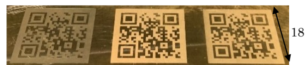
(a) R0.3mm ボール (b) 先端角 90° (c) 先端角 120°
