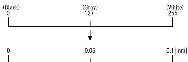
図-4 濃淡情報から深さ情報への変換例
