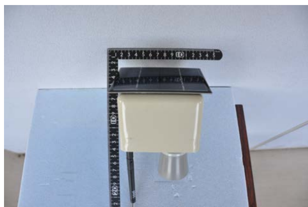
写真-1 小型水位計の外観
