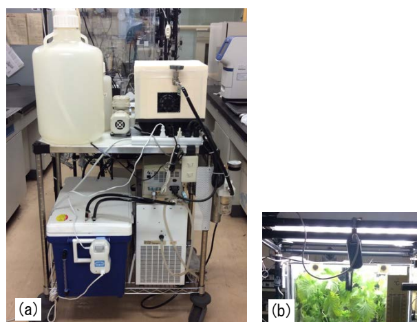
図-3 「カレ・デ・ベール plus」の(a)環境制御モジュールと(b)画像およびデータ収集・解析モジュール
