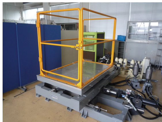
写真-6 新たに導入された構造物振動台の概観 (2016 年 9 月 26 日撮影)
