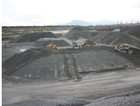
写真-1 新日鐵住金株式会社 大分製鉄所構内における大気エージング処理用製鋼スラグ山の一例 (2015年1月23日撮影)
