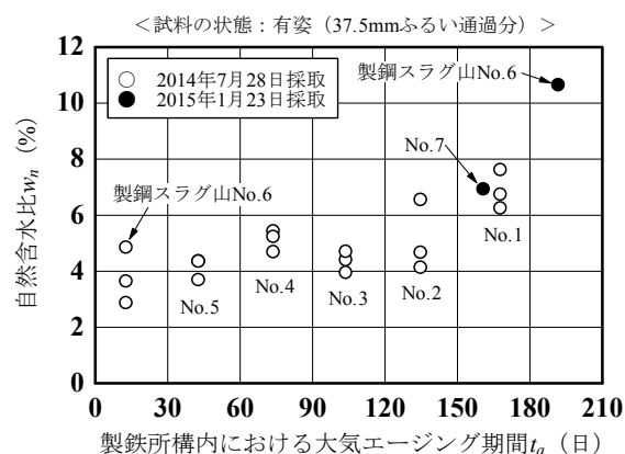
図-1 製鉄所構内における大気エージング期間の経過とともに自然含水比 w_n の推移(試料の状態: 有姿(37.5mmふるい通過分))
