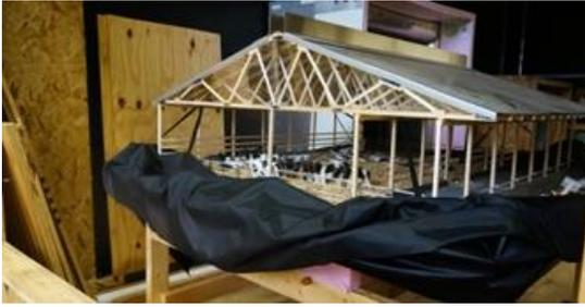
図-14 キャップストーンプログラム（牛舎風洞実験）の実施
