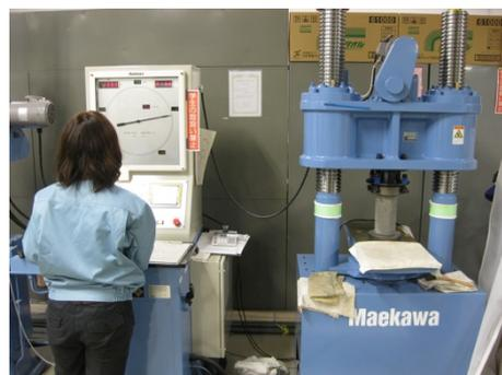
写真2 コンクリート圧縮試験の様子
