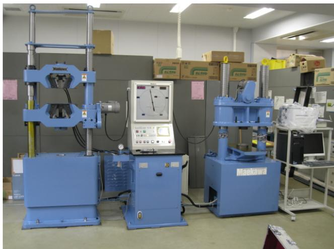
写真1 500kN万能試験機(左側)と2000kN圧縮試験機(右側)の全景
