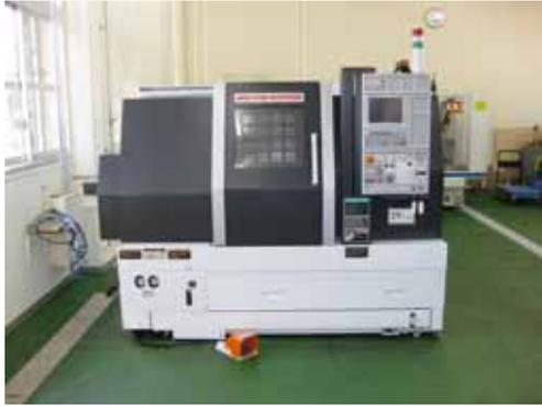
写真3 CNC 旋盤(MORI SEIKI DuraTurn 2050)
