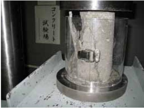
写真1 コンクリートの圧縮試験
