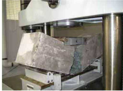
写真2 コンクリートの曲げ試験
