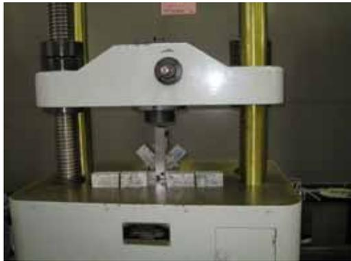
写真3 モルタルの曲げ試験
