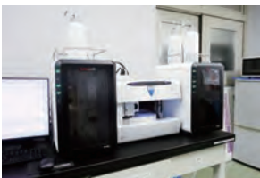
イオンクロマトグラフィー
