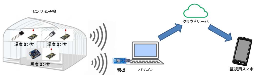
図1 植物工場や農業用ハウスでの環境データモニタリングシステム
